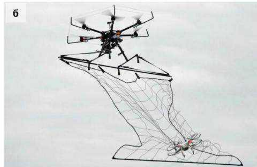
Рис. 2. Противодроновые беспилотники: а – дрон-камикадзе DroneBullet канадской AerialX; б – дрон-перехватчик с сетью
