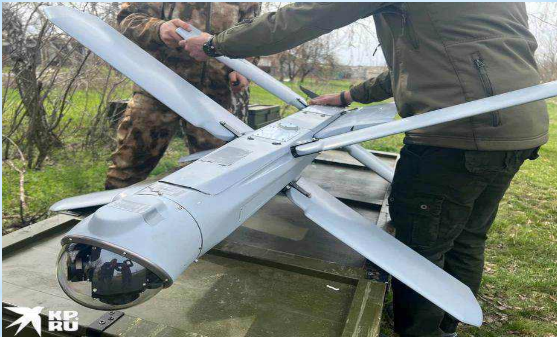
Беспилотник «Ланцет» барражирующий боеприпас с крыльями-перьями и навигационным модулем
