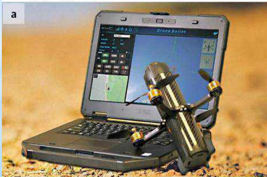
Рис. 2. Противодроновые беспилотники: а – дрон-камикадзе DroneBullet канадской AerialX; б – дрон-перехватчик с сетью
